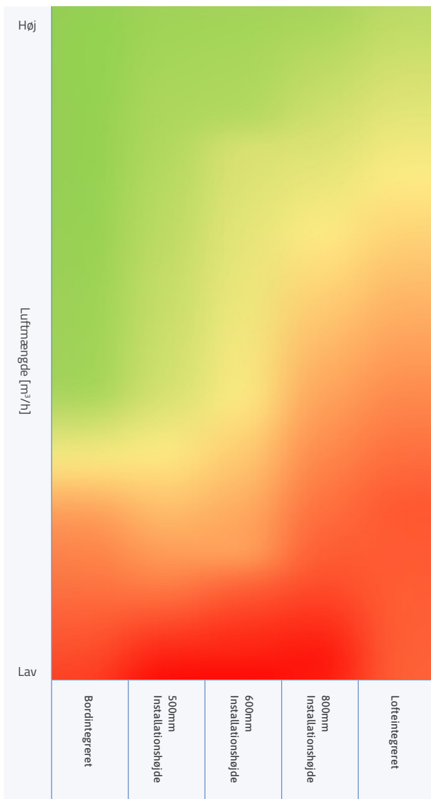
Figur 1: Luftmængde og afstand til kildens betydning for partikelfjernelsen af ultrafine partikler
