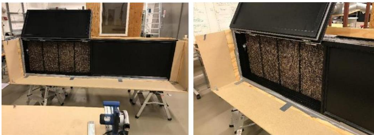
Figur 6.1. luftindtagssiden udefra, klap sektion med en lodret monteret hængslet drejeklap 50x90 cm her helt oppe.
