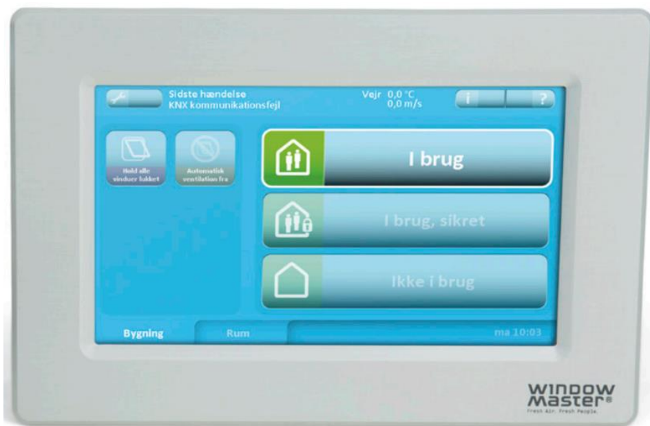
Figur 5.9. NV Komfort styreenhed fra WindowMaster hvor fra systemet kan betjenes. WindowMaster's styresystem består desuden af motorcontroller, vinduesmotorer, rumsensorer og en vejrstation.
