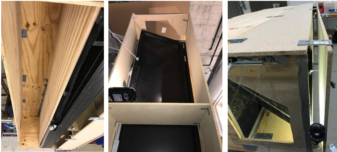
Figur 6.4. Mockup TI indeklimalab. Til venstre ses lamelfront efter fulgt af filter hvorfra luften kommer ind i klassen. I midten det regulerbare spjæld/blædparti, der sidder midt i vægelementet. Til højre ses den sprække der simulerer hvordan luften komme ind gennem facaden via. en 50 mm sprække omkring ventilationshullet.
