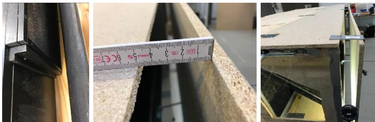
Figur 6.3. Tv: Overgang mellem ålegræsfilter og fast sektion. I midten ses lufttagsspalte rundt om ålegræsfilret. Th: Frontplade med inspektionsluge.
