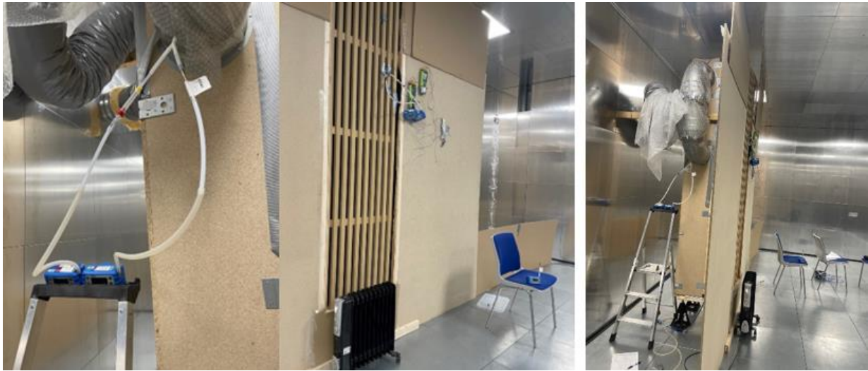
Figur 7.2. NOTECH filterelement. Mockup Indeklimalaboratoriet. Tv: Udeluft-Indblæsning (IN) (10,4°C) Mf: Udblæsning filterelement NOTECH til rum (10,4°C) + rumluft (på stol) (27,4°C). Th: Hele opstillingen (mock-up) med luftprøvetagninger før og efter NOTECH filterelement
