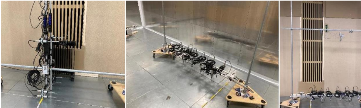
Figur 6.8b. Tv. Eksempel på målinger i normalplan ud for NOTECH-element, der blev udført med og uden hjælperadiator. Mf. Eksempel på måling lavt over gulv, her i lang afstand fra NOTECH element. Th. Flytbar måleopstilling for måling lavt over gulv.
