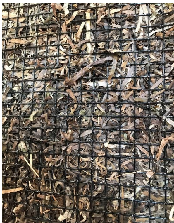
Figur 3 – Billede af ålegræsfilter holdt på plads af volierenet
