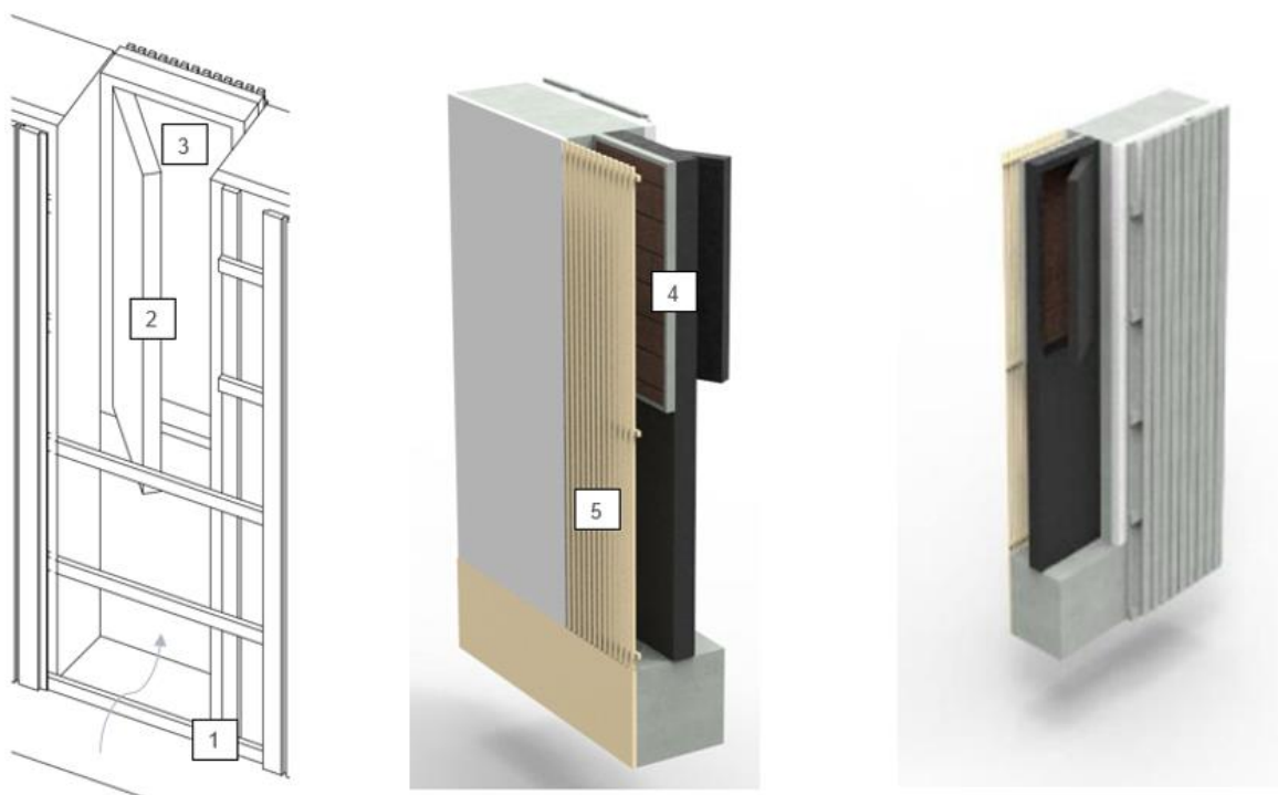
Figur 5.1. principtegning, inderside. Ålefilter ses i øvre side, indbygget stilbar klap for regulering af luftflow ses på luftindtagssiden. Th. 2 Principtegning set fra udvendig side. I øvre del ses en lodret hængslet klap foran ålegræsfilteret.
