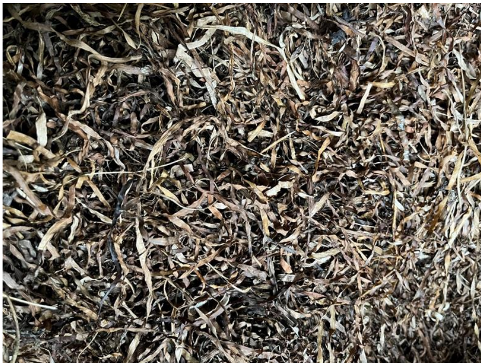
Figur 5.10. Ålegræsset i NOTECH-elementet består af relativt lange blade og stængler, som kan være mere end 50 cm lange.
