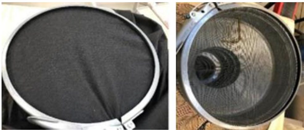
Figur 6.6. Tryktab målt over delelement i NOTECH-elementet. Måling på meget tæt filternet (akustisk filt) tv samt meget åbent insektnet, th. Det tætte filternet var uegnet pga. det reducerede tryktabet. Dvs. placeret indenfor lamellerne.
