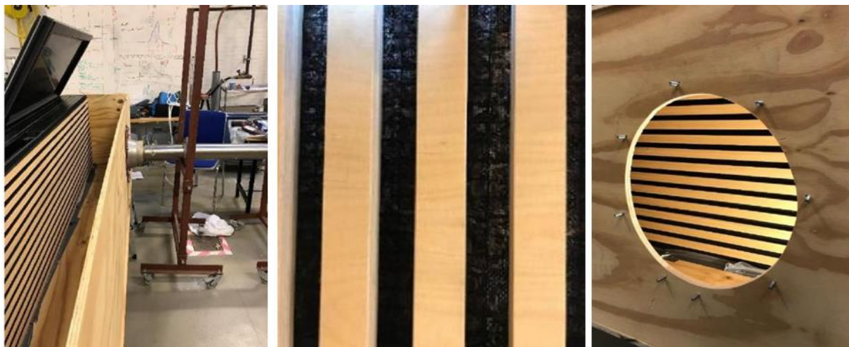
Figur 6.2. Indvendig side af lameller ses her i åben trykmåleopstilling. Lameller er på indvendig side beklædt med forskellige filttyper. Th: Indvendige lameller set gennem flowmålehul til trykmåleopstilling.
