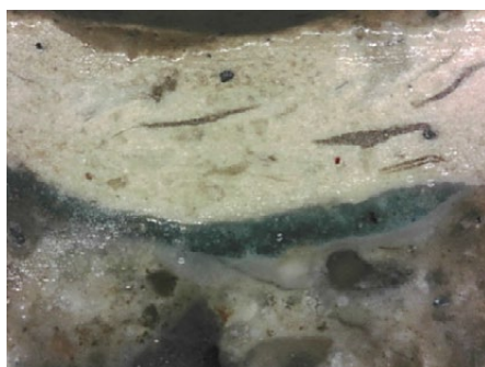
Strandparken 7-9, detalje af facadens overflade, optaget ved 200x forstørrelse.
