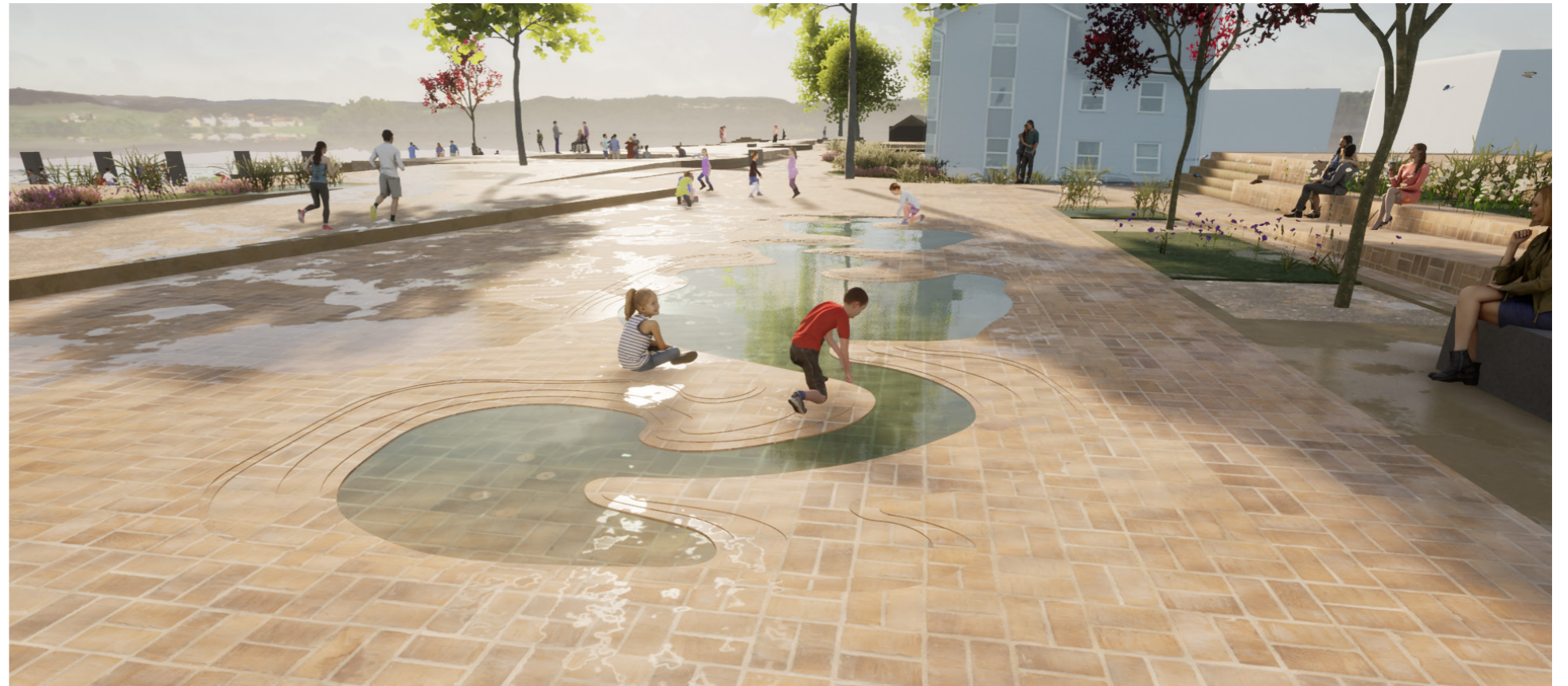
Fig. B: Teglstenene i kvadratmønster er visse steder fræset i menneskeskabte kotehøjder med få millimeters mellemrum for at forsinke regnvand og lade folk interagere med vandspejlet
