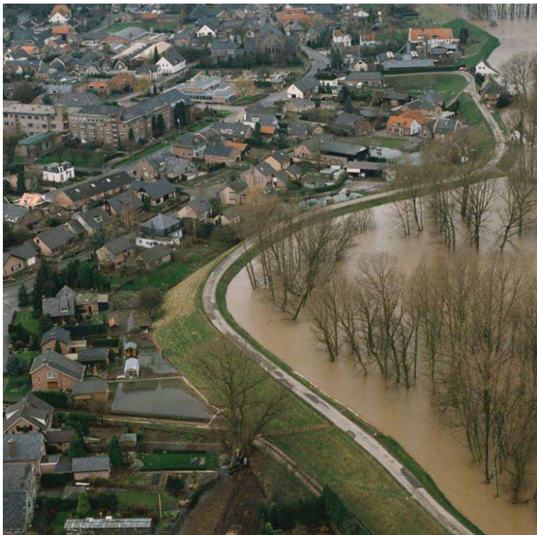
Figur 3.4 Eksempler på den udbredte anvendelse af lokale diger mv til at styre arealanvendelsen i hhv. nyudvundet land (øverst) og omkring de store åer, hvor landsænkning ofte gør, at vandspejlet er højere end det omgivende landområde (nederst). Billeder downloaded fra er fra https://www.sfgate.com/travel/article/Exploring-Holland-s-charming-Polder-Country-5613997.php#photo-6559430 og https://landscapeiskingston.files.wordpress.com/2014/01/r4r11.jpg
