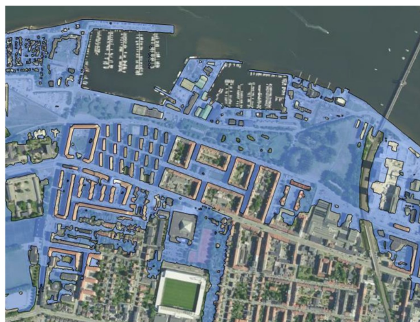
Oversvømmelse ved kote 2,4 m.
