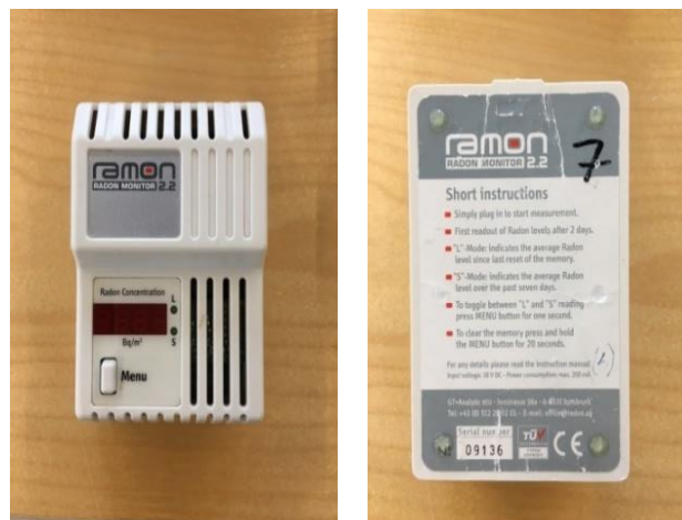
Ramon Radon monitor 2.2 - Elektronisk radonmåler anvendt uden for fyringssæsonen
