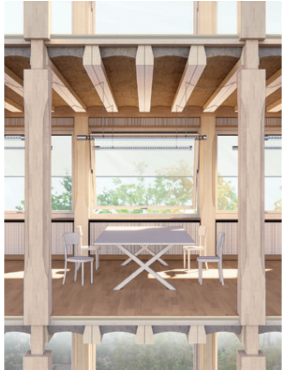
Stampede lerhvælvinger opnår vederlag på de skråt affasede massive bjælker i bøg. Leren bidrager med termisk masse, trinlydsdæmpning og brandbeskyttelse. Søjlerne er i lamineret bøg. © Herzog & de Meuron
