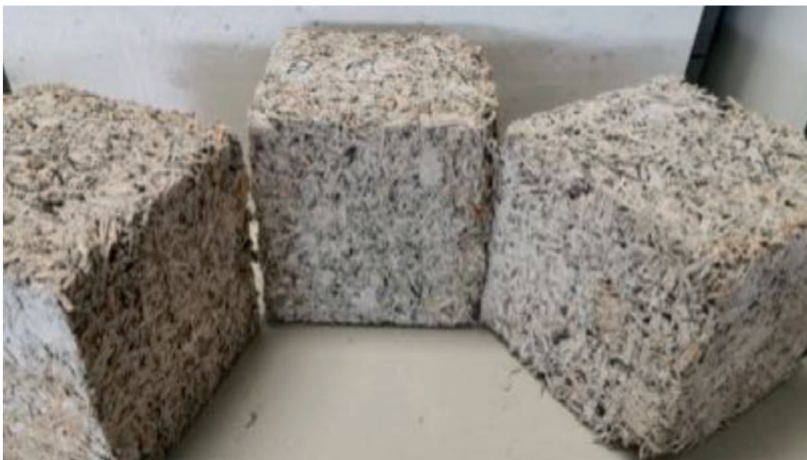
Fotos fra artikel af prøver af rapsbeton til (a) mekanisk test og (b) test af varmeledningsevne. © Obeid, Douzane ,Dutra, Promis, Laidoudi, Bordet, Langlet
