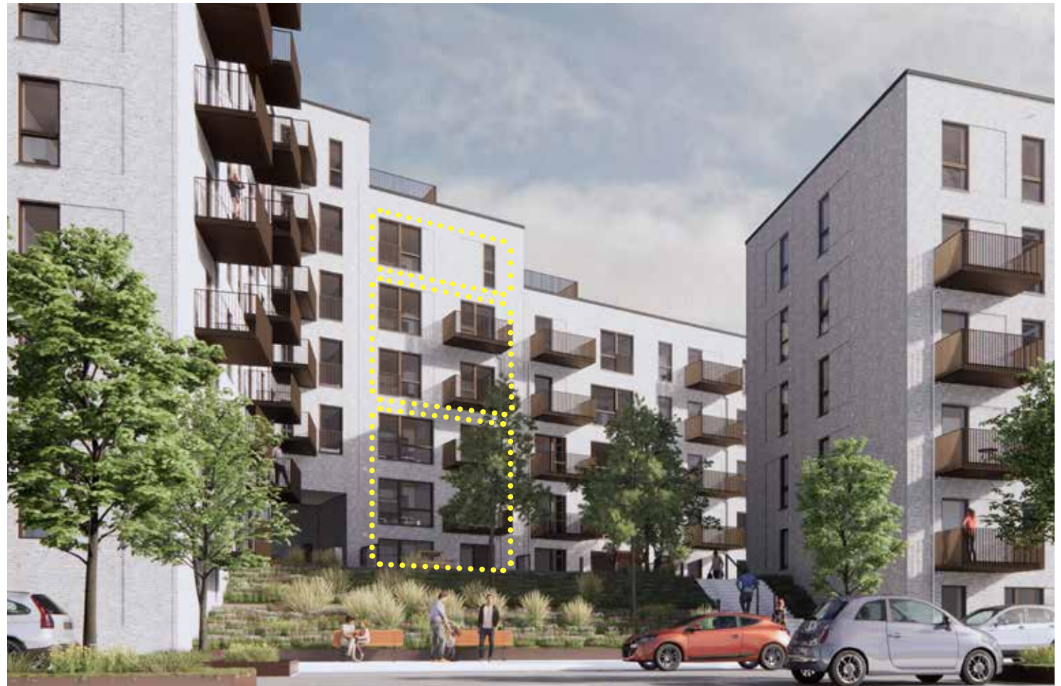
Figur 4.25 Byggeri med varierende vinduesstørrelse afhængig af etage og skyggeforhold.
