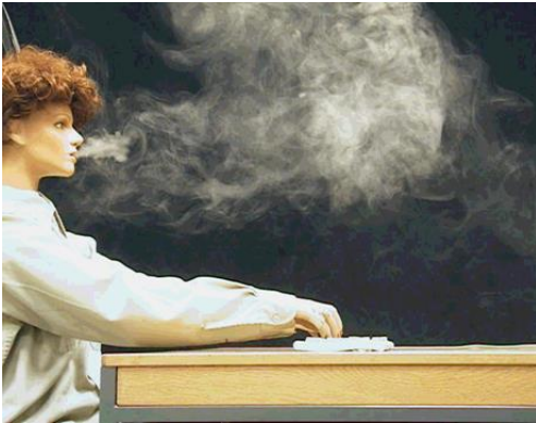
Fig. 6. Visualisering af luft der udåndes gennem munden af åndedrætsdukke.
