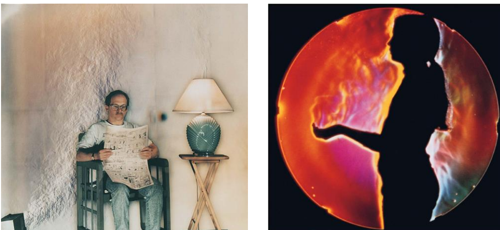
Fig. 7. Schlieren-fotografier i fuld skala: a) person b) stående pige (Settles 1997).
