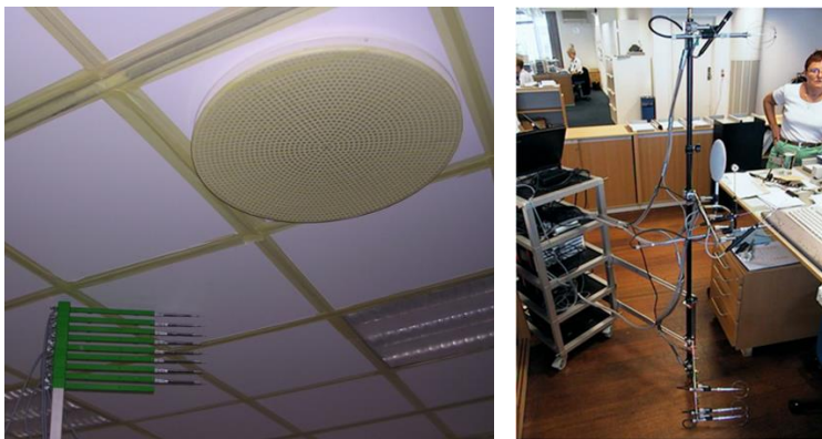
Fig. 10 Lavhastighedsanemometer med flere transducer anvendes til måling omkring lufttilførselsarmatur og b) under feltmålinger (4 hastigheds- og temperaturtransducere er fastgjort til armen på en vogn med forskellige måleinstrumenter).
