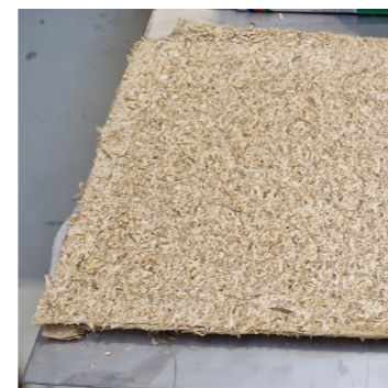
Plade prototype Densitet 841,54 kg/m 3
