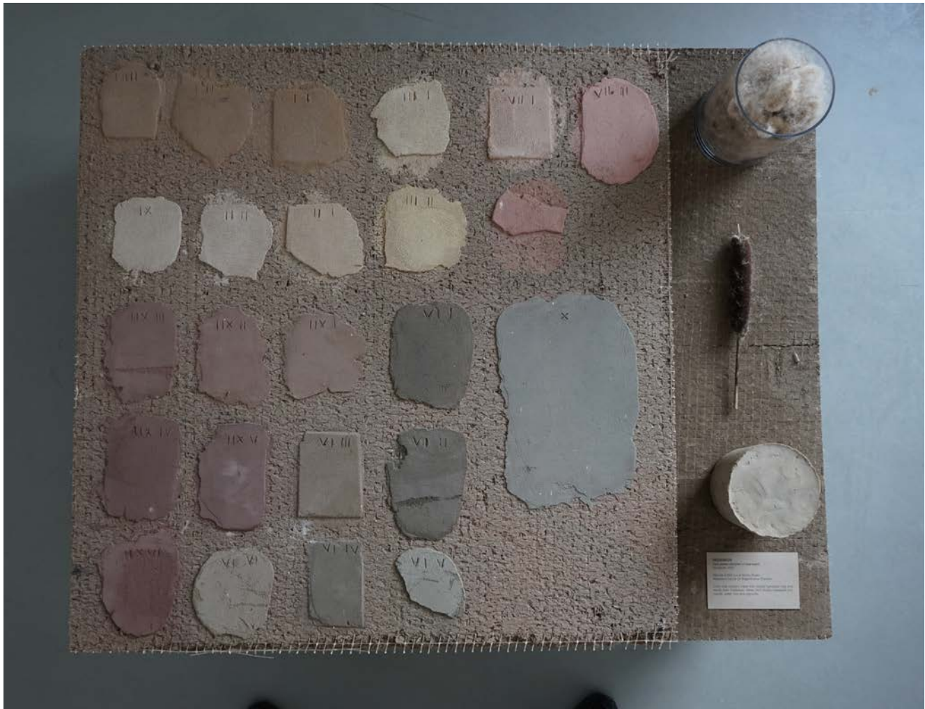
↑ Prøver af lerpuds blev opstrøget som led i workshop med Local Works Studio. Farvesætning er inspireret af GEUS kernescanning samt af farver anvendt i den gamle skolebygning
