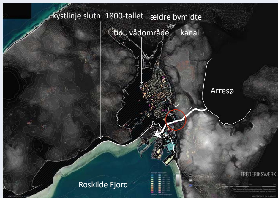
Figur 47: Øverst: Kort over Frederiksværk som den så ud i slutningen af 1800-tallet på De Høje Målebordsblade (1862-99) Nederst: Frederiksværk i 2023. En større del af byen er placeret i tidligere vådområder og større industriområder er opbygget på tidligere havbund. En kanal forbinder Isefjorden med Arresø og vandstandene fra begge sider styres med sluse, pumpestation og diger.
