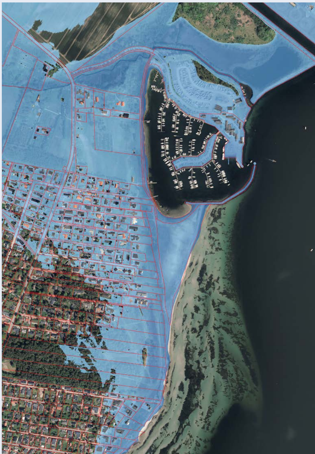
Figur 76: Eksempel på del af et sommerhusområde der i 2020 overgik til byzone og dermed også gav mulighed for helårsbeboelse. Luftfotoet er overlejret med matrikler (røde figurer) sammen med en 100-års hændelse i år 2120 ud fra RCP8,5, 2,8 m over DVR90. Kilder: Matrikler: Matrikelkort, Geodatastyrelsen, CC BY 4.0 Ortofoto Nyeste Ortofoto 2025, Geodanmark, CC BY 4.0 Havvandsstigning: Danmarks Hydrologiske Højdemodel, DHM/Havvand på Land, Klimadatastyrelsen, WMS-version 1.0.0 CC BY 4.0.
