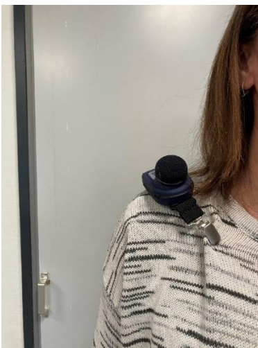
Figur 6. Placering af dosimeter på skulder
