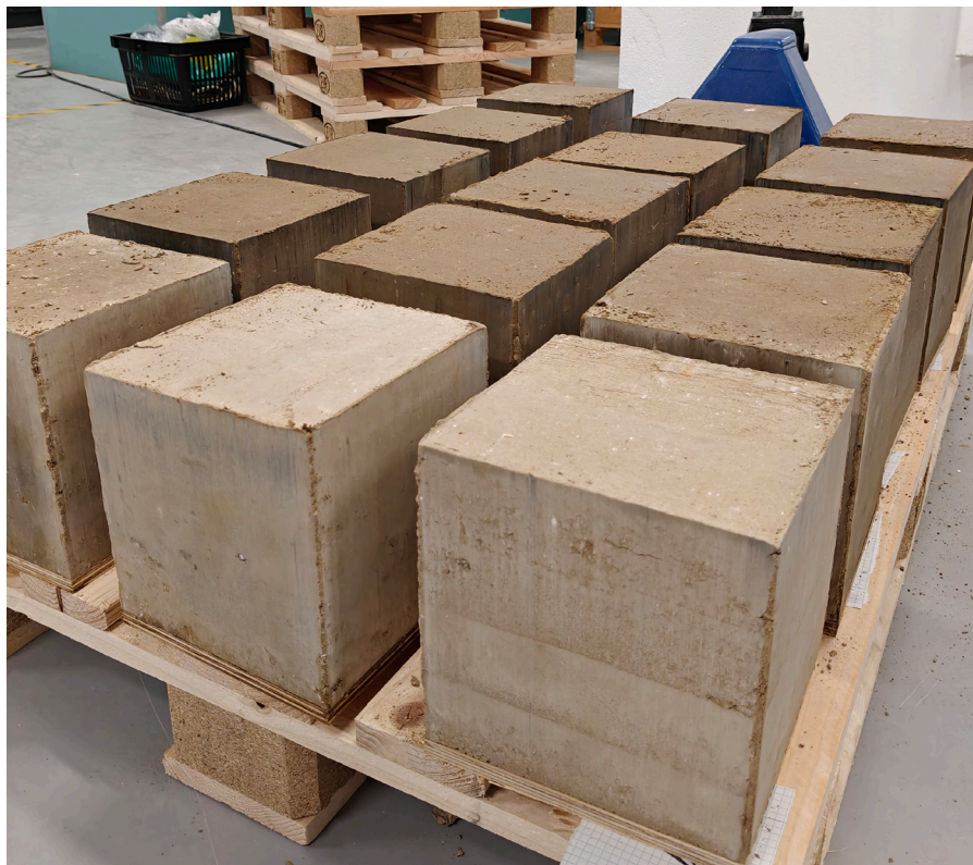
Robotautomatiseret produktion af kuber (200x200x200 mm) til testforløb hos Robot at Work
