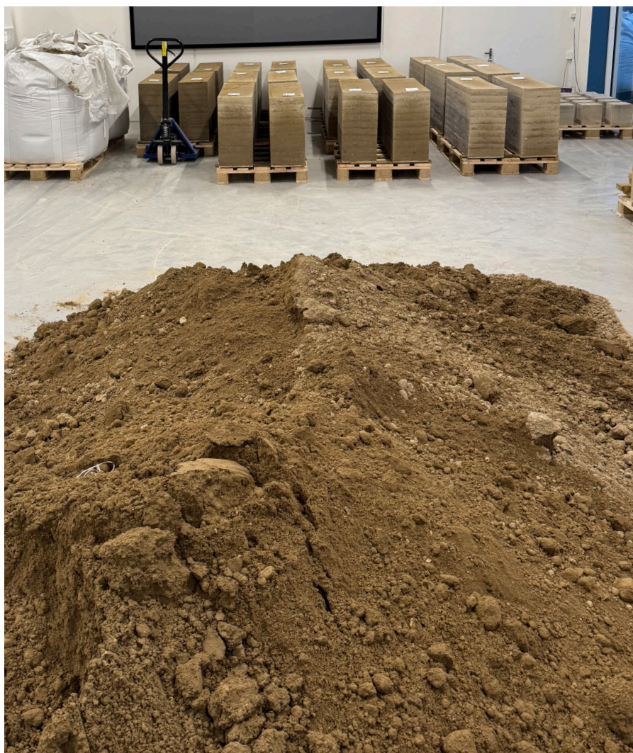
Råmaterialet spredes i produktionshallen til tørring grundet for høj fugtighed, inden det stemples. I baggrunden står de første elementer til tørring i 6-8 uger, før de testes.
