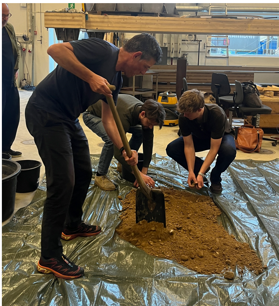
Workshop hos AU: Råjord skovles ud på gulvet for at vurdere homogenitet og fugtindhold – en praktisk test, hvor materialet både undersøges visuelt og mærkes med hænderne
