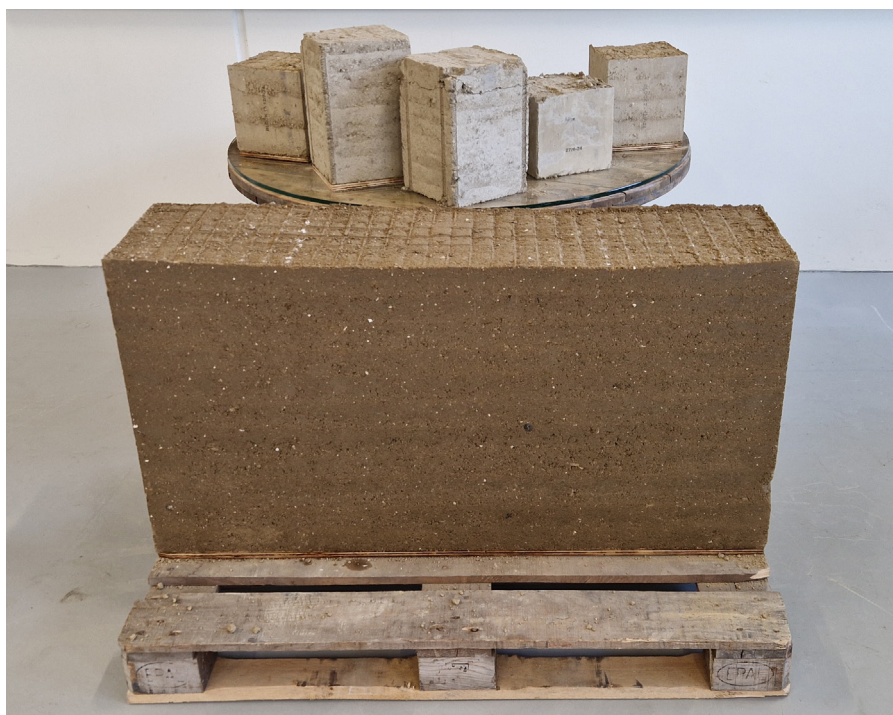
Det første robotstampede lerjordsselement og test på kubniveau
