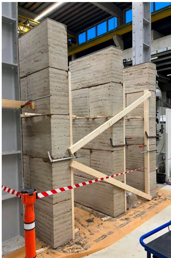
Prøverne efter afretning med murermørtel på toppen
