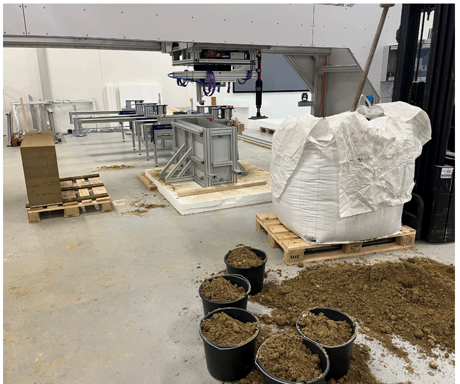
Produktionslinje hos Robot at work. Her ses det første element på palle, og i front illustreres den manuelle proces med påføring af råmateriale til form.
