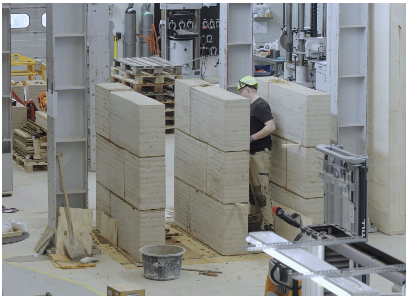
Opmurede vægge hos Teknologisk Institut før forskydningstest
