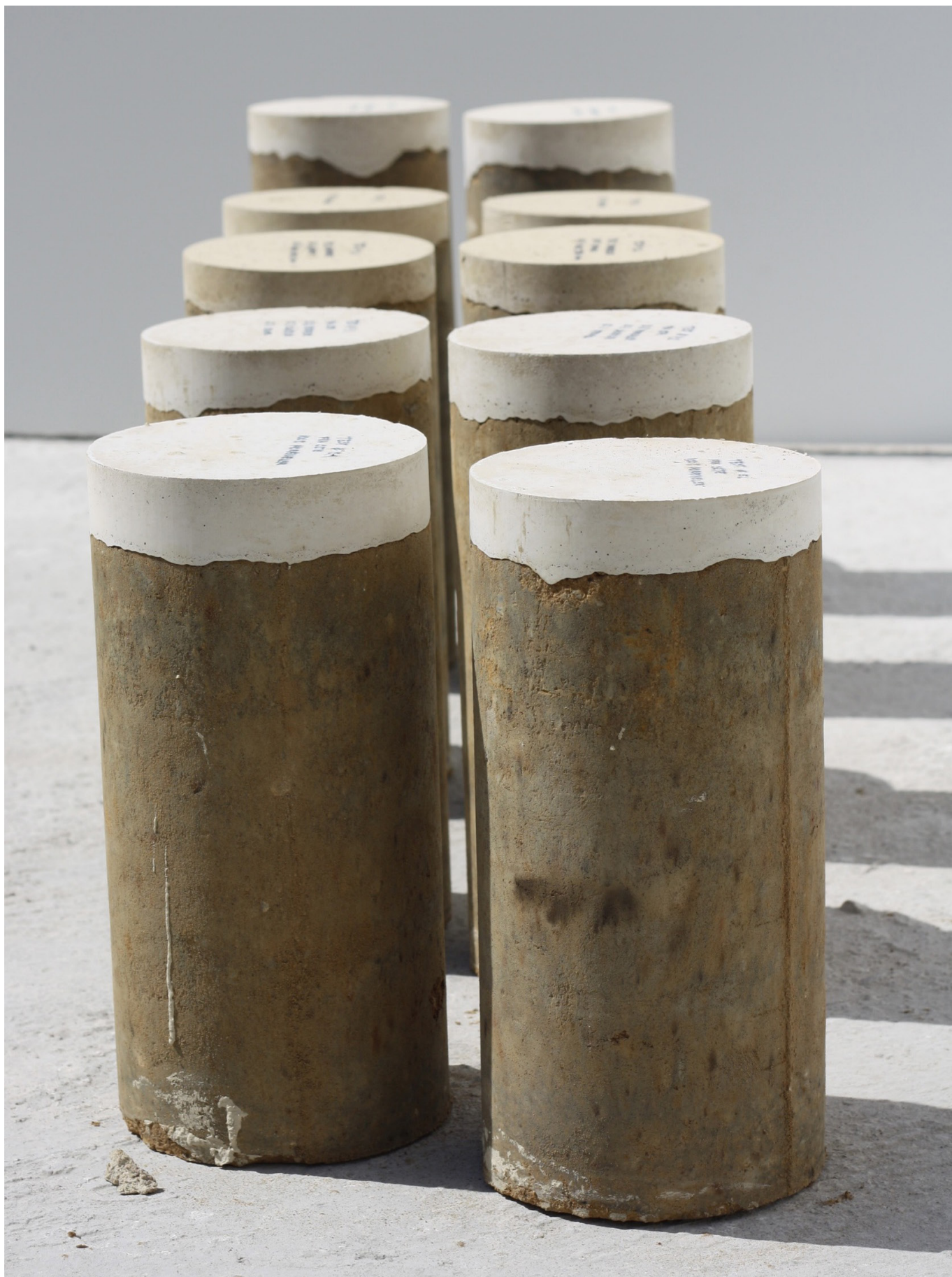
Cylindre med afretningslag til test
