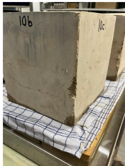
Absorption test - billeder af prøver efter 3 timer
