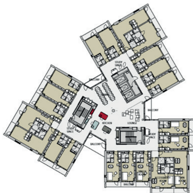
Figur 10. Situationsplan 6. Etage med de tre tårne, hvori der er placeret syv boligenheder, som deler gangplads, og som skal igennem fælleskøkken og -opholdsstue i miden, hvor elevatoren også er placeret © C.F. Møller Architects
