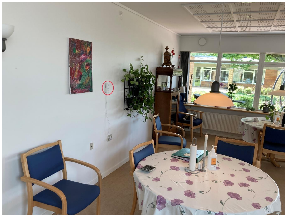
Figur 2. Indeklimalogger hængt op i midten af et fællesområde.
