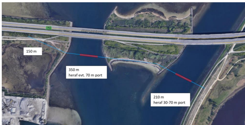
Figur 4-3 Løsning Midt. Samlet længde på ca. 710 meter, med tre alternativer for portåbninger: 1) 70 meter i både Sorterende (mod vest) og Kalvebodløbet (mod øst), 2) 70 meter i Kalvebodløbet og 3) 30 meter i Kalvebodløbet.
