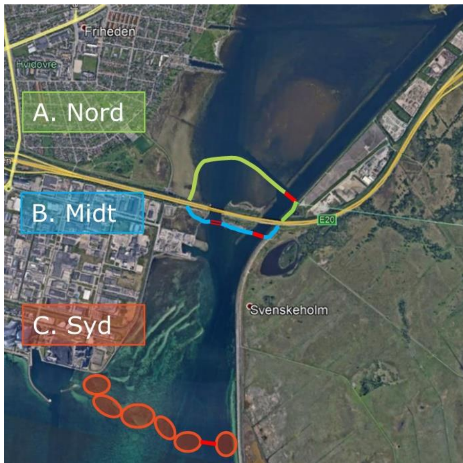
Figur 3-1 Princip for placering af dæmninger og porte ved de tre hovedløsninger.
