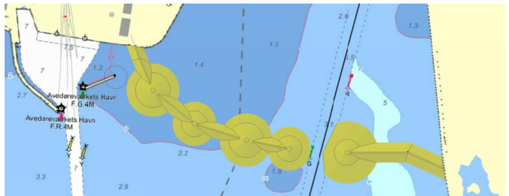
Figur 7-4 Alternativ løsning Syd. Samlet længde på ca. 1.660 meter, heraf en port på 70 meter ved sejlrunden mod Kalveboderne. Antallet og højden af øerne kan varieres, ligesom længden og placeringen kan justeres ud fra ønsket sammenhæng med naturpark Amager og de planlagte holme. Rød = Øer med 2 meters ekstra højde. Grøn = Øer med designhøjden (+6.7 m). Gul = Forbindelses-dæmninger med designhøjden. Alle øer har 20 meter strand mod Køge Bugt og 20 meter eng mod Kalveboderne.
