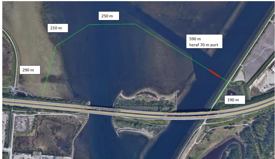
Figur 4-2 Løsning Nord. Samlet længde på ca. 1.530 meter, heraf en portåbning på 70 meter i Kalvebodløbet, evt. suppleret med rør ved Sorterende.
