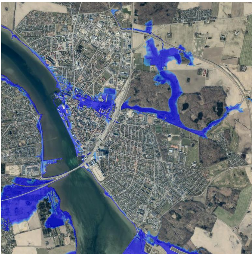
Figur 1-2: Områder i Nykøbing, der oversvømmes ved en stormflod i kote +2,5 meter, jf. SCALGOLive.
