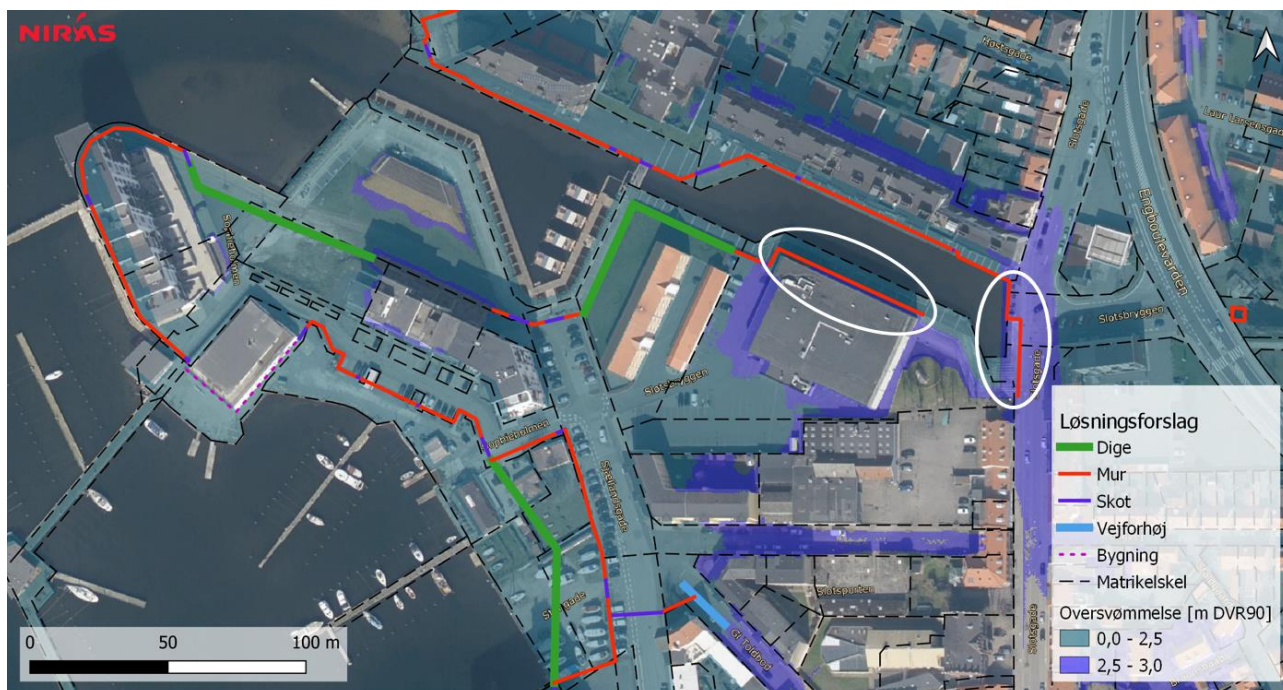
Figur 6-13: Alternativ 1, Indre løsning og eksisterende pumpeplacering ved Delområde 3. Cirkler markerer den ekstra beskyttelse til kote +3,0m DVR90. Ortofoto: (SDFI, 2021).
