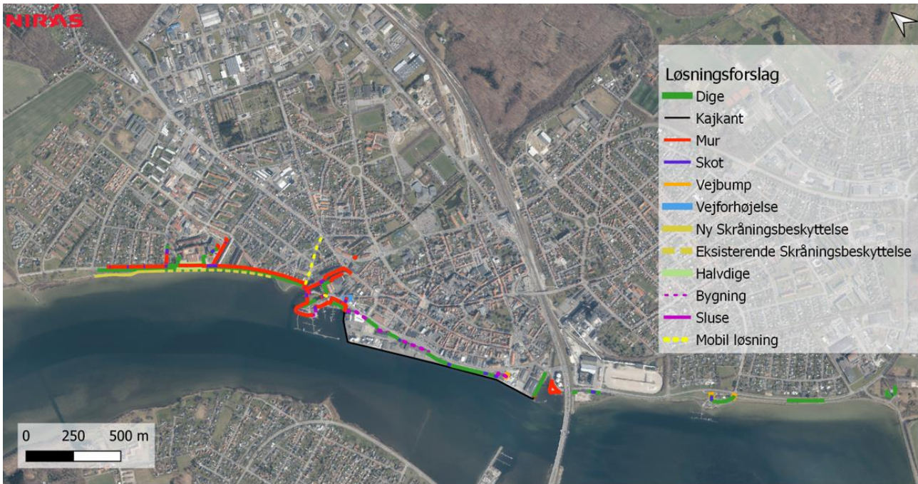
Figur 2-1: Forslag til højvandssikring af Nykøbing. Der er flere alternativer til højvandssikring for flere af strækningerne.
