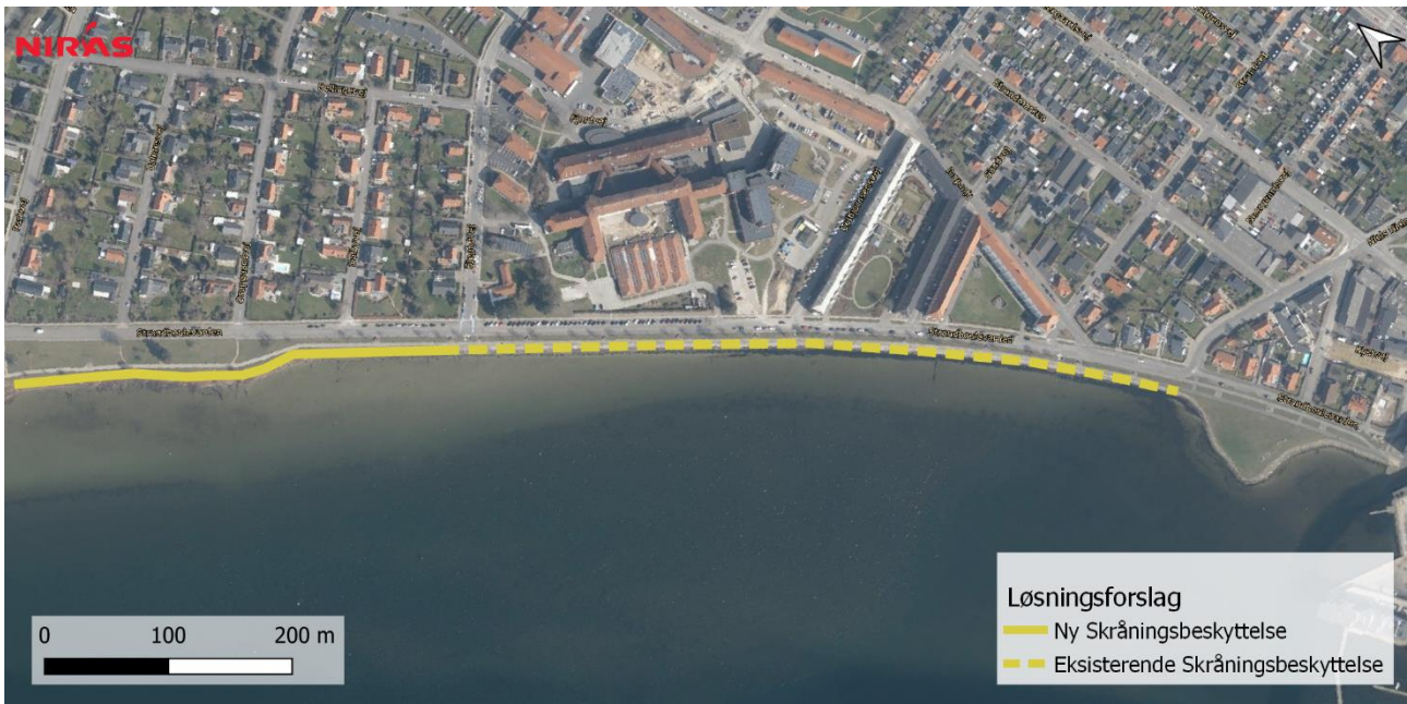
Figur 6-3: Skråningsbeskyttelse i Delområde 2. Ortofoto: (SDFI, 2021).
