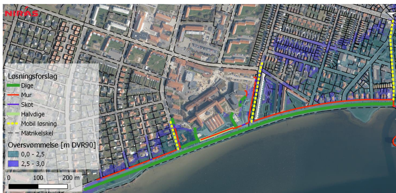
Figur 6-7: Mulig etapeinddeling ved mobile løsninger. Ortofoto: (SDFI, 2021). Et halvdige er en højvandsbeskyttelse der har en mur som den landværts side og krone og forside (havværts side) som et dige.
