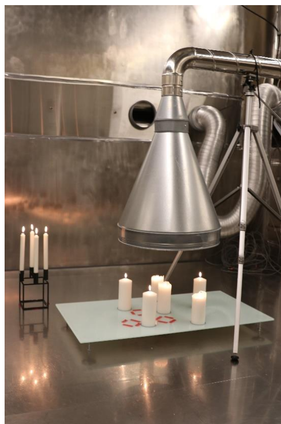
Billedeserie 1. Billederne viser forsøgsopsætningen i det lille kammer ved hhv. stegeos hhv. stearinlys. Billedet af forsøgsparticipanterne er taget i det store kammer.
